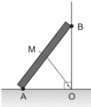
Assim, a distância de M até O é metade do comprimento da viga de aço, pois M é circuncentro do triângulo AOB (ponto médio da hipotenusa).
